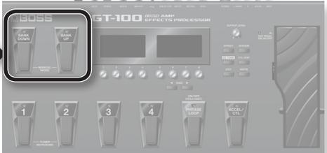
2. Schalten Sie mit den Pedalen die Effekte ein bzw. aus.
