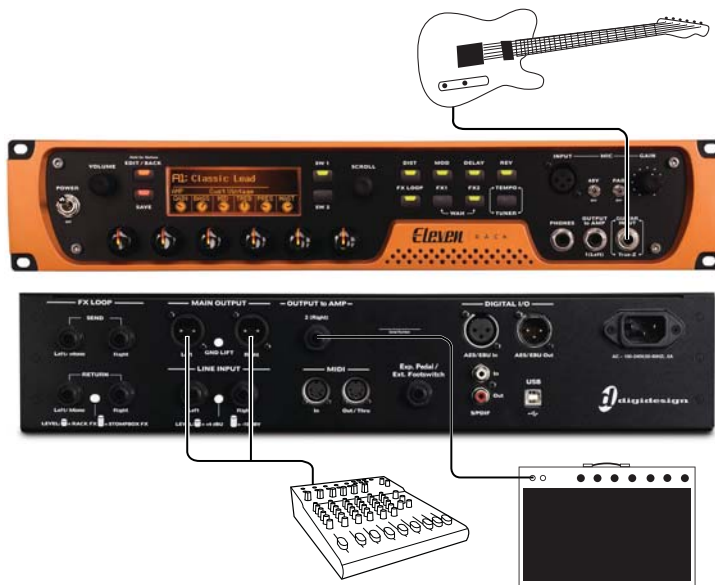
Figure 6. Eleven Rack connecté à une console de sonorisation et à un ampli sur scène
