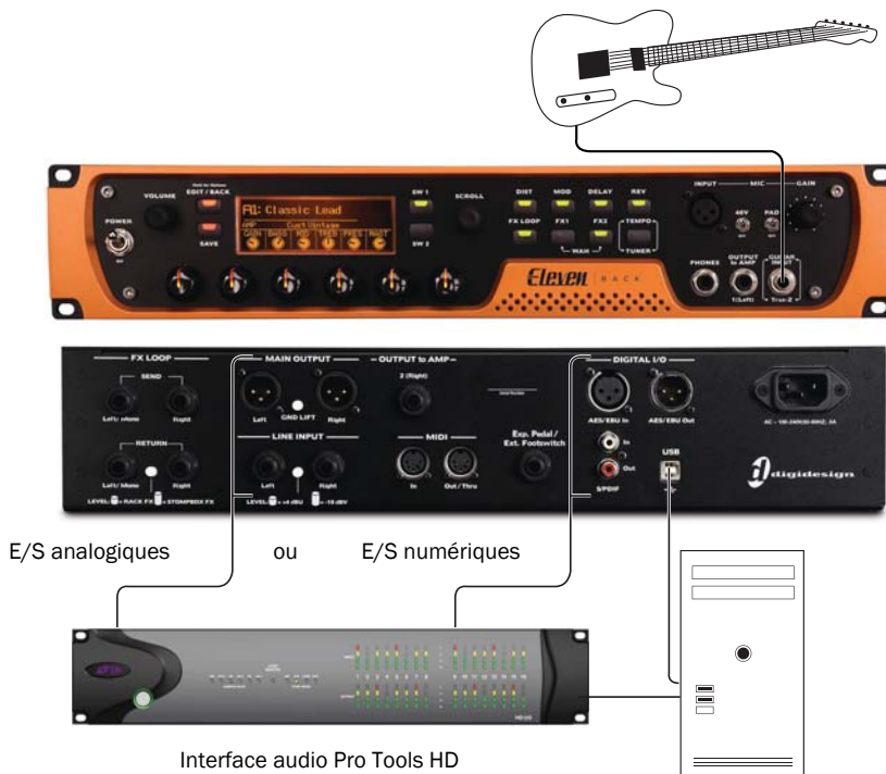
Figure 9. Eleven Rack connecté à un système Pro Tools | HD
