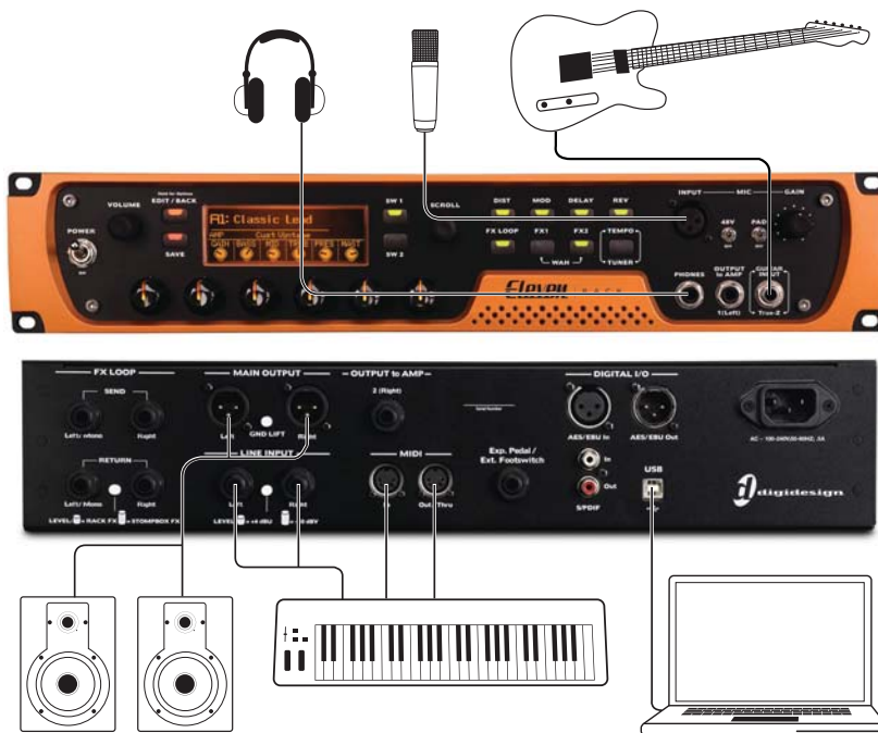
Figure 8. Configuration de studio avec Eleven Rack comme interface audio Pro Tools
