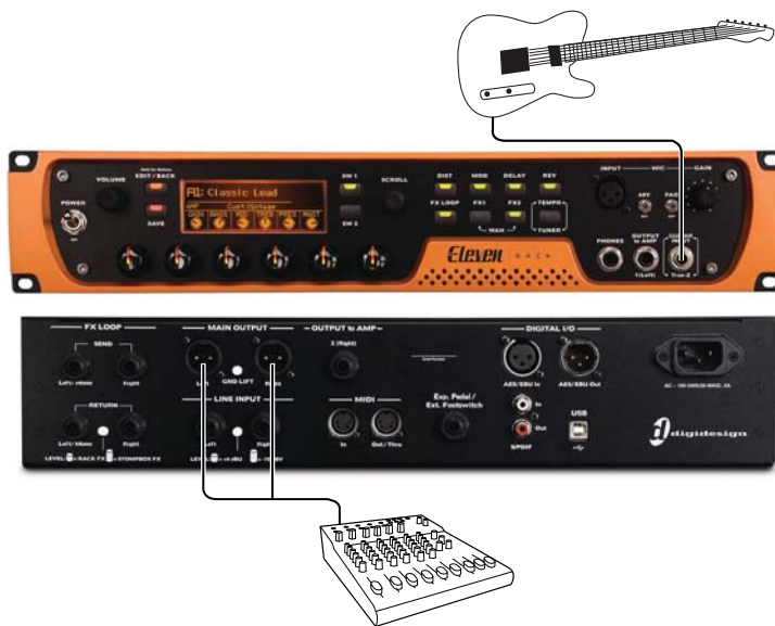
Figure 5. Eleven Rack connecté directement à une console de sonorisation
