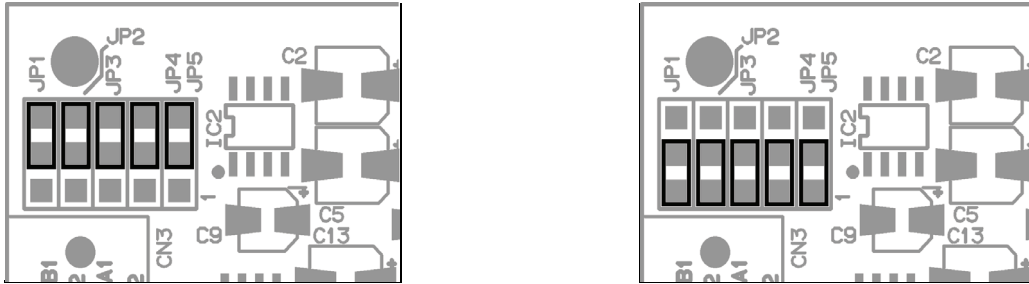
Abbildung 4.2: Jumperstellung in Pre-Fader-Betriebsart (links) und Post-Fader-Betriebsart (rechts)
