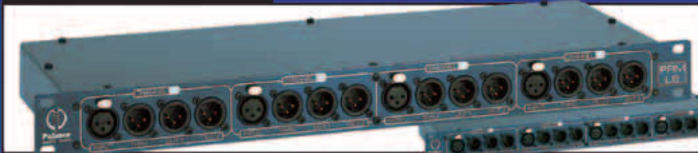
**PRM-MS** - Mikrofon Splitbox 4-Kanal passiv im 1 HE/19" Gehäuse mit pro Kanal einem Eingang, einer Parallelbuchse (Ausgang zum Durchschleifen der Phantomspeisung), und zwei trafogetrennten Ausgängen. Zusätzlich durch Widerstände entkoppelt.
