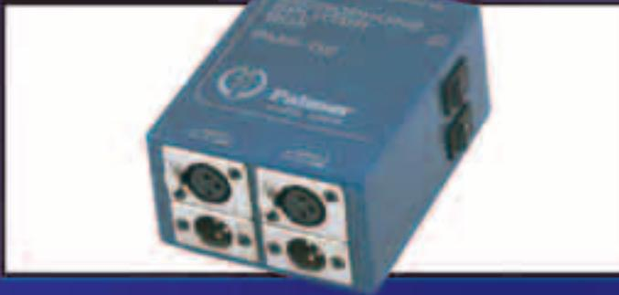
**PMS-02** - Passive zweikanalige Mikrofonsplitbox. In gleicher Ausführung wie die PLS 02 ist die PMS 02 vom Pegel und der Impedanz auf optimale Übertragung von Mikrofonsignalen entwickelt. Über die parallele Thru-Buchse kann die Phantomspeisung durchgeschliffen werden, so daß auch Kondensatormikrofone problemlos eingesetzt werden können.
