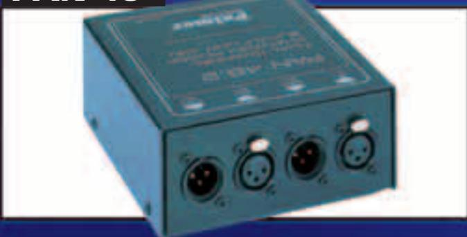
Palmer PAN 48 ist ein Gerät zur externen Spannungsversorgung phantomgespeister Geräte. Auf Grund der hohen Stromleistung von total 20 mA ist die Anwendung nicht nur auf Kondensatormikrofone beschränkt, PAN 48 eignet sich auch hervorragend, um z. B. phantomgespeiste aktive DI-Boxen zu versorgen. Die Box ist zweikanalig ausgelegt.
