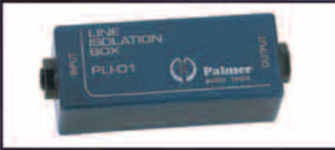
**PLI-01** - Einkanalige Ausführung im Aludruckgussgehäuse mit Klinkerein- und -ausgängen. Wird erfolgreich in Gitarrenracks eingesetzt, wo mehrere Effektgeräte, Vorverstärker usw. zusammenschaltet werden müssen. Die Box wird aber auch im CAR-HIFI Bereich eingesetzt, um Pfeifgeräusche von Powerboostern zu beseitigen.
