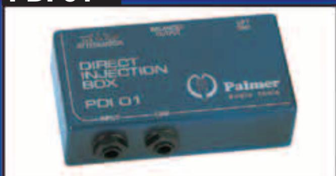
**PDI 01** - Die Passive DI-Box, deckt mehr als 90% der Standardapplikationen ab. Kein Soundverlust durch extrem hochwertigen Symmetrieübertrager aus Mu-Metall, ausgeglichener Frequenzverlauf im gesamten Audiobereich von 40 Hz bis 20 kHz, maximale Übersteuerungsfestigkeit durch weiten Bereich der Anpassung. Mechanisch extrem robust durch Druckgußgehäuse aus einer speziellen Legierung, die zusätzlich für Einstrahlungsfestigkeit sorgt.
