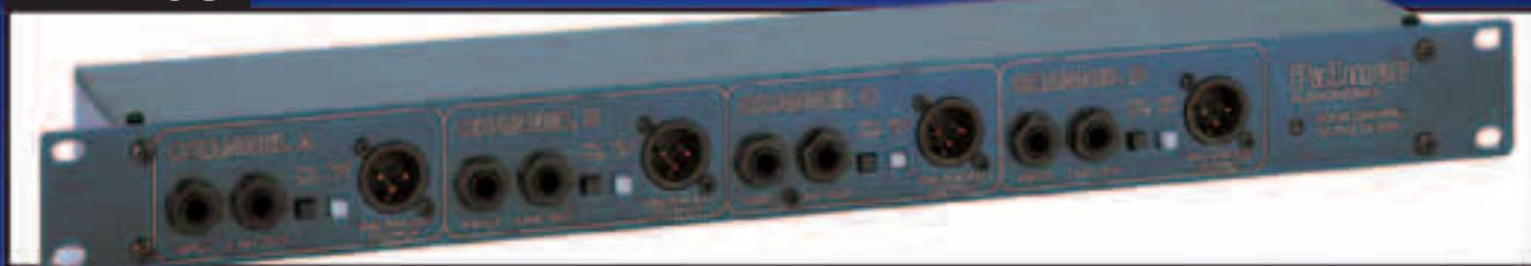
Aktive 4-fach DI-Box im 19"-Gehäuse. Die technischen Daten sind identisch mit der PAN 02. Jedoch wird die PAN 03 generell netzgespeist (Steckernetzteil fest mit dem Gerät verbunden). Alle Anschlüsse und Schalter befinden sich auf der 1 HE Frontplatte, der XLR-Ausgang ist als Parallelbuchse zusätzlich auf der Rückseite vorhanden. 19"/1 HE-Gehäuse, 90 mm tief.
