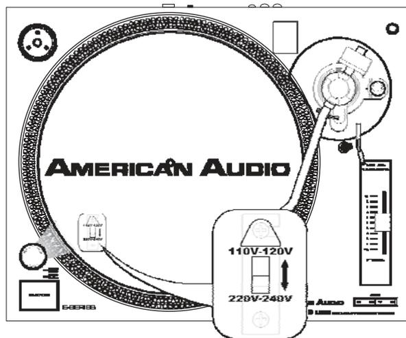
Ändern Sie niemals die Spannungsvorwahl. Ein Umschalten kann unter Umständen zu schweren Beschädigungen führen. Sollte der Spannungswahlschalter defekt sein, kontaktieren Sie bitte einen Fachmann zur Überprüfung.
