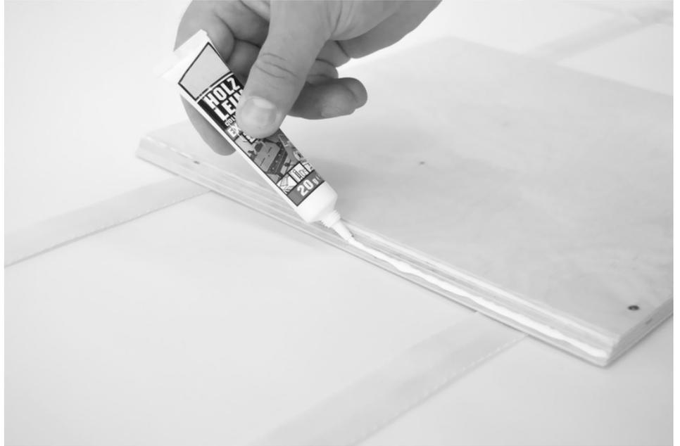
Stecken Sie die Seitenwände in die Fräskanten der Bodenplatte. Achten Sie beim Aufstellen der Seitenwände und dem Verkleben mit der Bodenplatte darauf, dass die Kanten bündig abschließen.
