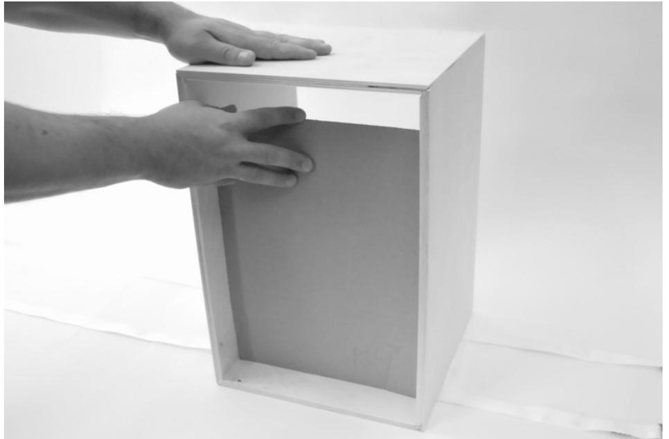
Legen Sie die Spanngurte über das Cajon und spannen Sie diese leicht.
