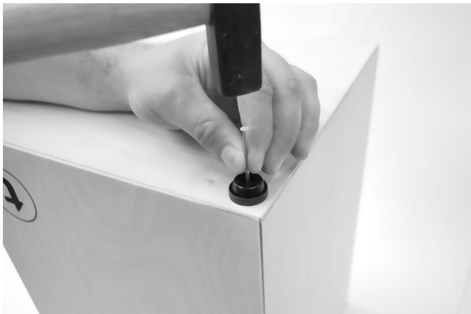
Schrauben Sie die GummifüÙe mit den vier Senkkopfschrauben in den Ecken der Bodenplatte fest.
