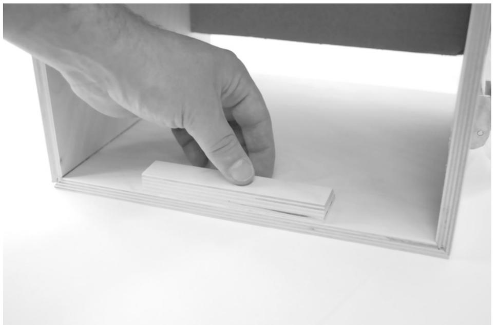
Fixieren Sie die Snareleiste mit zwei Nägeln in den vorgestochenen Löchern.
