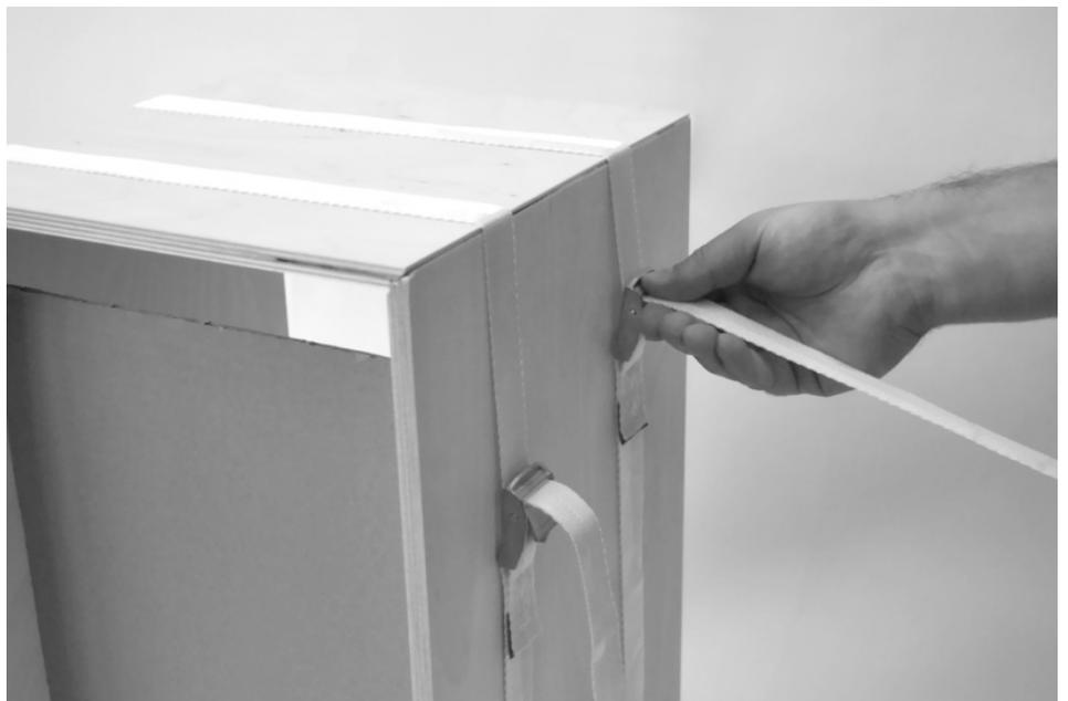
Legen Sie das Cajon waagrecht auf die Anpressplatte und prüfen Sie die Verbindungen auf Bündigkeit. Korrigieren Sie diese bei Bedarf und spannen Sie die Spanngurte fest.
