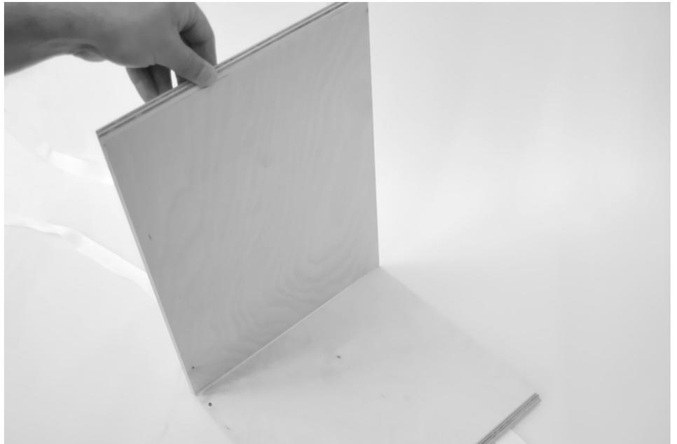
Nachdem Sie die beiden Seitenwände mit der Bodenplatte verklebt haben, prüfen Sie diese auf Bündigkeit und verkleben Sie die Deckplatte auf gleiche Weise.
