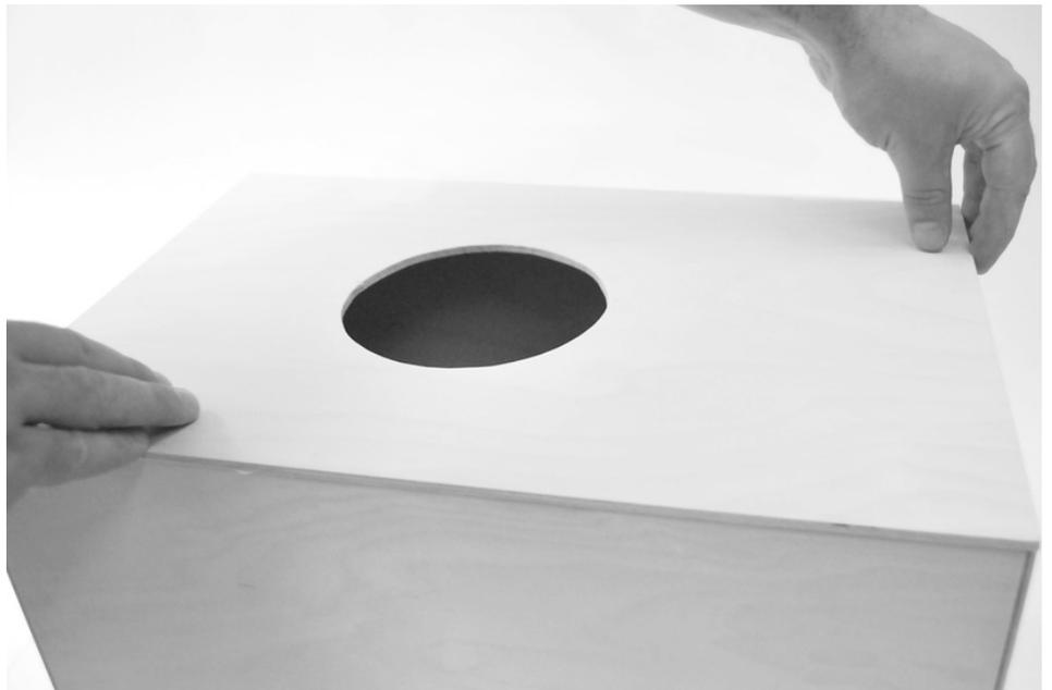
Legen Sie die Anpressplatte auf die Rückwand, prüfen Sie die Kanten auf Bündigkeit und drücken Sie die Anpressplatte kurz an.
