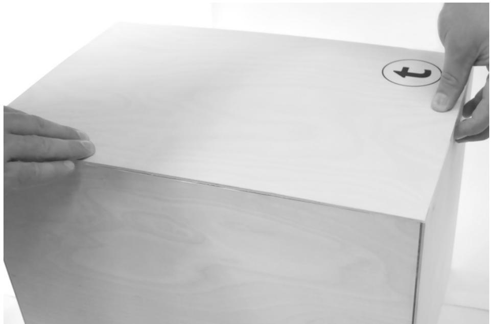
Legen Sie die Anpressplatte auf die Schlagfläche, prüfen Sie die Kanten auf Bündigkeit und drücken Sie die Anpressplatte kurz an.
