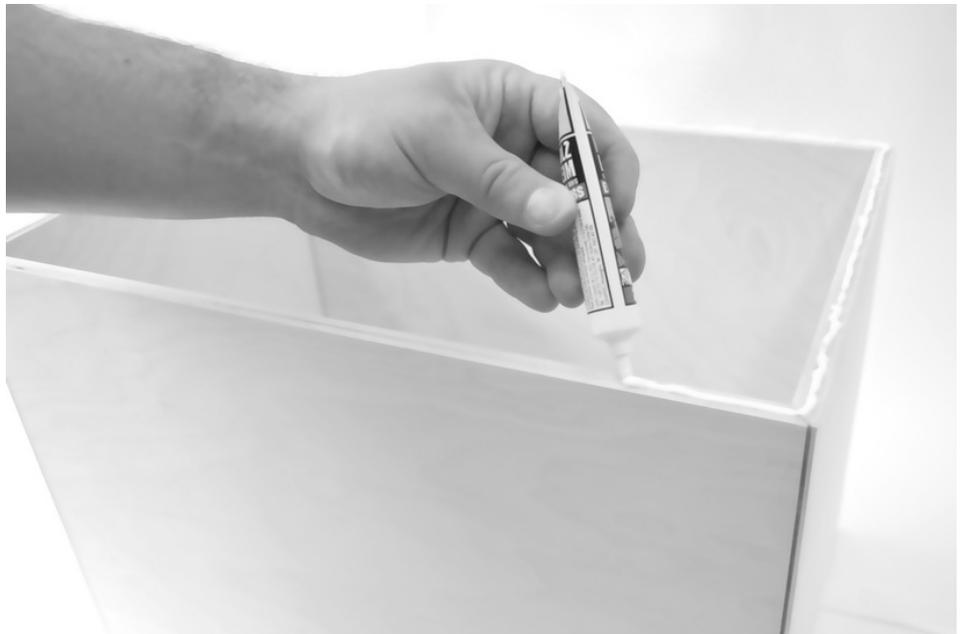
Setzen Sie die Rückwand bündig auf die Kanten auf und drücken diese kurz an.
