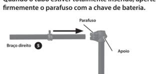
1-4. Quando o tubo estiver totalmente inserido, aperte firmemente o parafuso com a chave de bateria.
