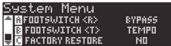
Drehen sie an den **Knöpfen A** und **B** um den Fusschalter auf die Funktionen **R** bzw **T** einzustellen .
