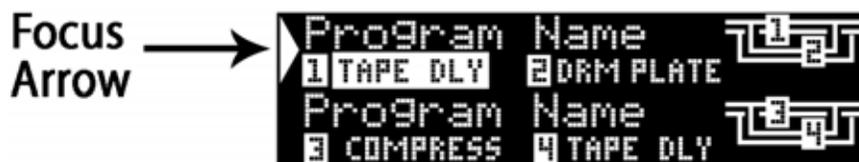
Beispiel: Sobald der Effekt 1 oder der Effekt 2 hervorgehoben sind, können sie das Programm durch drehen am **Program/Load** Knopf verändern. Dies wird ihnen in der oberen Hälfte der Hauptanzeige dargestellt (Programm A). Sobald der Effekt 3 oder 4 hervorgehoben ist, verändert das drehen am **Program/Load** Knopf das Programm das in der unteren Hälfte der Hauptanzeige dargestellt wird (Programm B).
