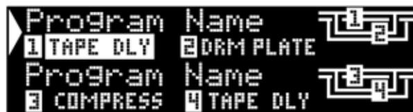
Die Editier Knöpfe **A**, **B** und **C** verändern in dem Fall folgende Parameter des Tape Delays: Tempo, Delay Zeit und Feedback. Zusätzlich können Sie in der Surround und Stereo Anwendung des MX400 auf verschiedene andere Parameter im **Edit Effect** Menü zugreifen.
