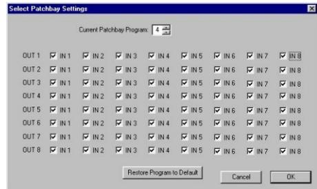
Bsp. 4 routet alle Eingänge auf alle Ausgänge (Thru + Merge Funktion: 8x8)
