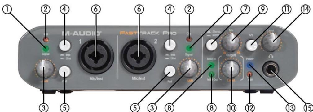
1. **Voyants de signal (Signal)** : Le voyant Signal s'allume en vert quand un signal d'entrée de  $-24\text{dBFS}$  est détecté.
