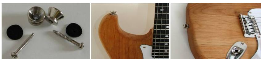
Die Abbildung auf den Fotos links zeigt nochmal die Gurtknöpfe (Nr. 18) und an welcher Stelle diese angebracht werden sollen. **Auch hier gilt:** markieren, vorbohren, und festschrauben.
