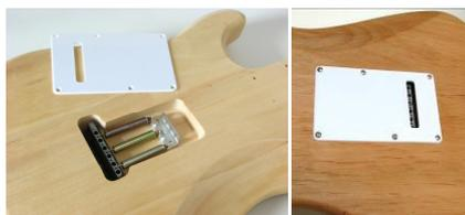
Die Abdeckplatte für die Federhalter auf der Rückseite des Gitarrenkorpus (Nr. 7) sollte vor dem Verschrauben so ausgerichtet werden, dass die vorgestanzten Löcher ein späteres Aufziehen der Saiten ohne große Umstände ermöglichen (Fotos links), danach kann sie festgeschraubt (Nr. 14) werden.
