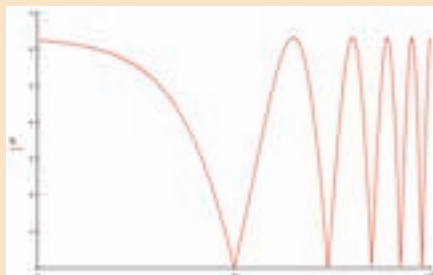
Schematische Darstellung des Kammfiltereffekts auf einer logarithmischen Frequenzachse.
