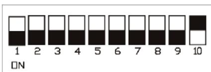
Stellen Sie DIP Schalter 10 auf ON um das Slave Gerät festzulegen. Dip Schalter 1 – 9 sind auf OFF.
