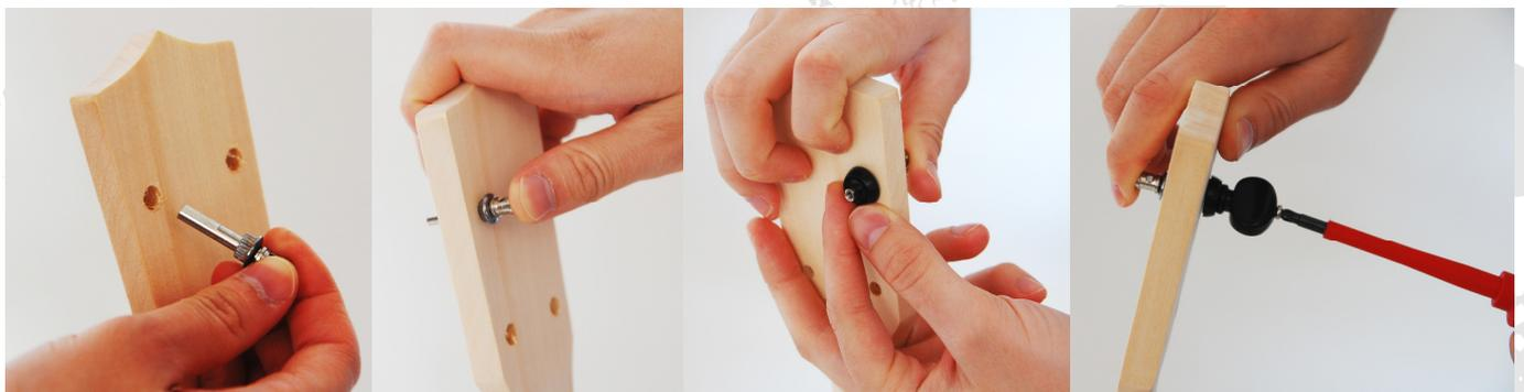
Anschließend werden auf der Rückseite der Kopfplatte die eigentlichen Wirbel aufgesteckt und mit der dazugehörigen Schraube befestigt. Zu fest sollten die Schrauben allerdings auch nicht eingedreht werden, da sich die Wirbel später beim Stimmen der Saiten nur schwer oder gar nicht rotieren lassen.
