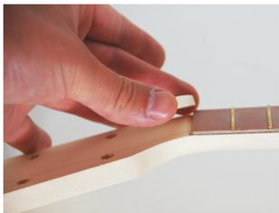
Der Obersattel (Nut), über den später die Saiten am Kopf zu den 4 Stimm-Mechaniken geführt werden, ist sehr einfach anzubringen. Er wird am Griffbrettansatz (Foto links), an dem bereits beschriebenen Übergang zur Kopfplatte eingeklebt. Dabei zeigt die Rundung der Nut in Richtung des Kopfendes. Anschließend wird die Brücke bzw. der Untersattel auf der Decke des Klangkörpers angebracht. Zum Verkleben und wegen der Haltbarkeit empfiehlt sich hier ein handelsüblicher Sekundenkleber.
